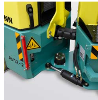
snodo oscillante lubrificato a vita rivestito in teflon
